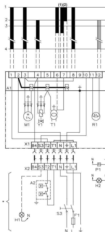
\* Si la chaudière n'est pas équipée d'une prise "européenne" (X2) utilisez celle fournie avec le brûleur. Si le thermostat double est en série sur la phase d'entrée, un raccordement entre les bornes T1 et T2 est nécessaire.
