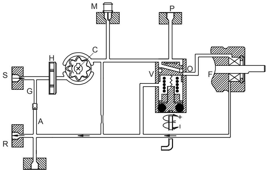
Si la pompe s'arrête, la chute de débit qui en résulte provoque une chute de la pression de fioul. Le ressort du régulateur pousse alors le piston jusqu'au contact avec le siège de la vanne en orifice "P": le débit de fioul vers le gicleur est coupé, coupure qui assure un isolement sûr et efficace du tuyau alimentant le gicleur.
